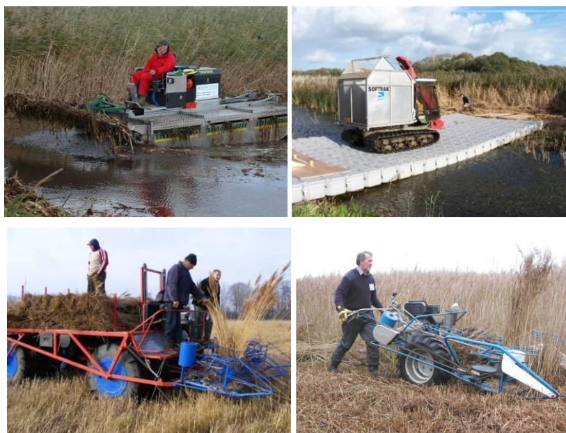
Εικόνα 30. Μηχανήματα διαχείρισης μεγάλης κλίμακας: Aquaclear «Truxor», Softrak, Seiga Harvester, παλινδρομική θεριστική μηχανή BCS
