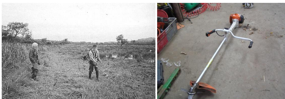
Εικόνα 28. (α) Χορτοκοπτικό σε λειτουργία (από RSPB 1996), (β) Χορτοκοπτικό αστεροειδούς λεπίδας Παλινδρομικές θεριστικές μηχανές
