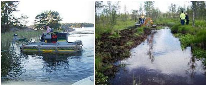
Εικόνα 24. Πλωτό μηχανήμα πολλαπλών ρόλων Aquarius Truxor (αμφίβια χρήση, κοπή, σκάψιμο, βυθοκόρηση)
